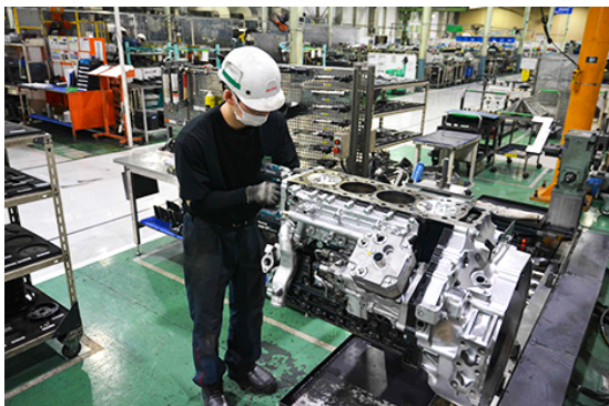
再組み立て中のリビルトエンジン
