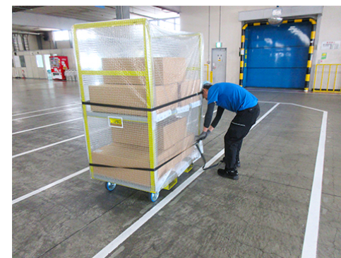
（変更後）ラッシングベルトを巻く作業
