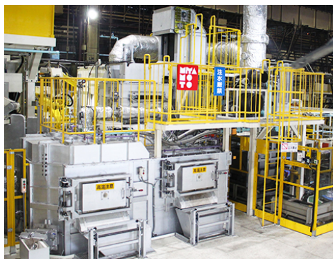
高効率アルミ溶解保持炉
