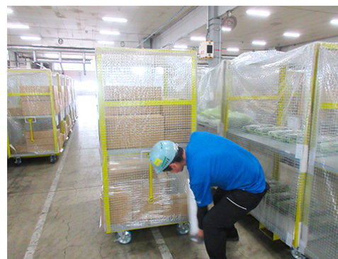
（変更前）ストレッチフィルムを巻く作業
